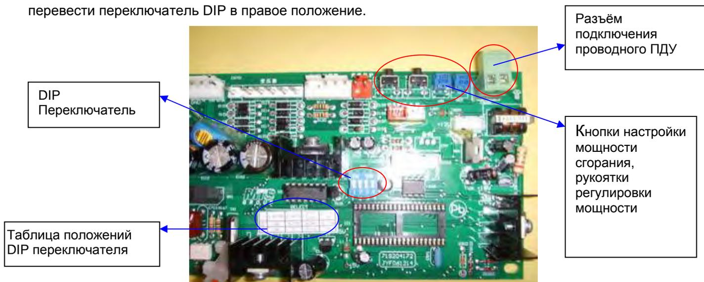
Кнопка настройки мощности сгорания и рукоятка регулировки мощности расположены рядом.
