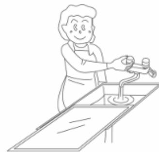
Д. Закрыть кран горячей воды, когда отключится звуковой сигнал. Звуковой сигнал означает, что достигнуто установленное значение расхода воды. На ЖК дисплее в течение 8 сек отображается миганием заданное значение расхода воды. После этого необходимо прекратить наполнение ванны.
