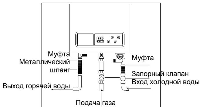
Подключение газовой трубы к выходу манометра
