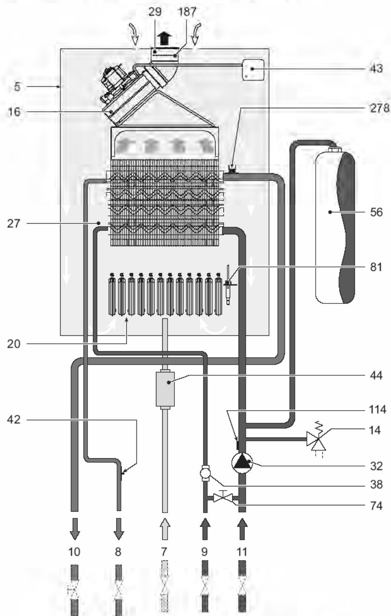
рис. 20 - Схема системы отопления и контура ГВС
