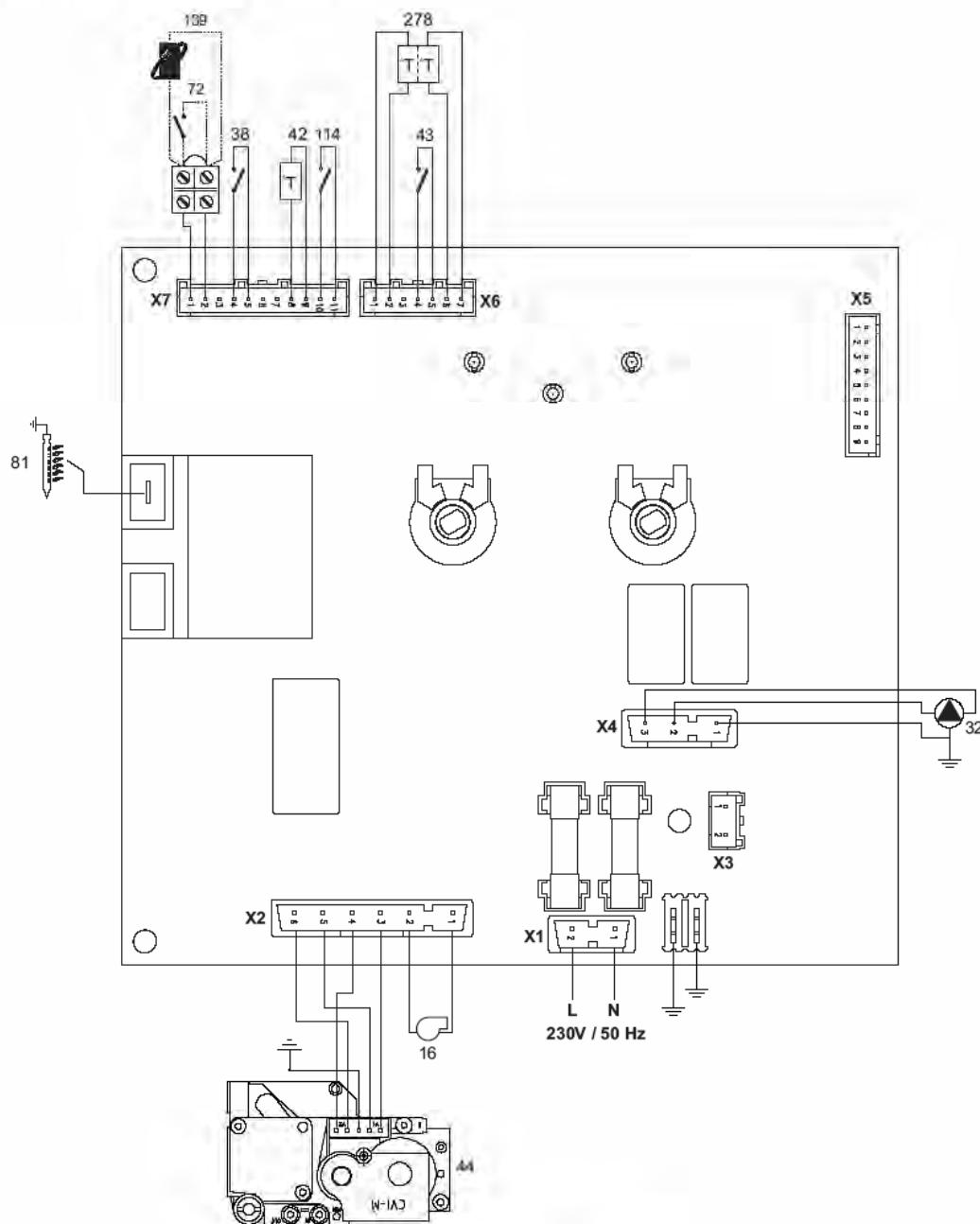
рис. 21 - Электрическая схема
