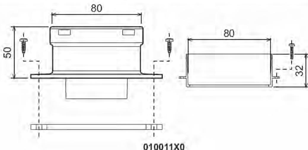
рис. 12 - Соединительный элемент для раздельных труб
