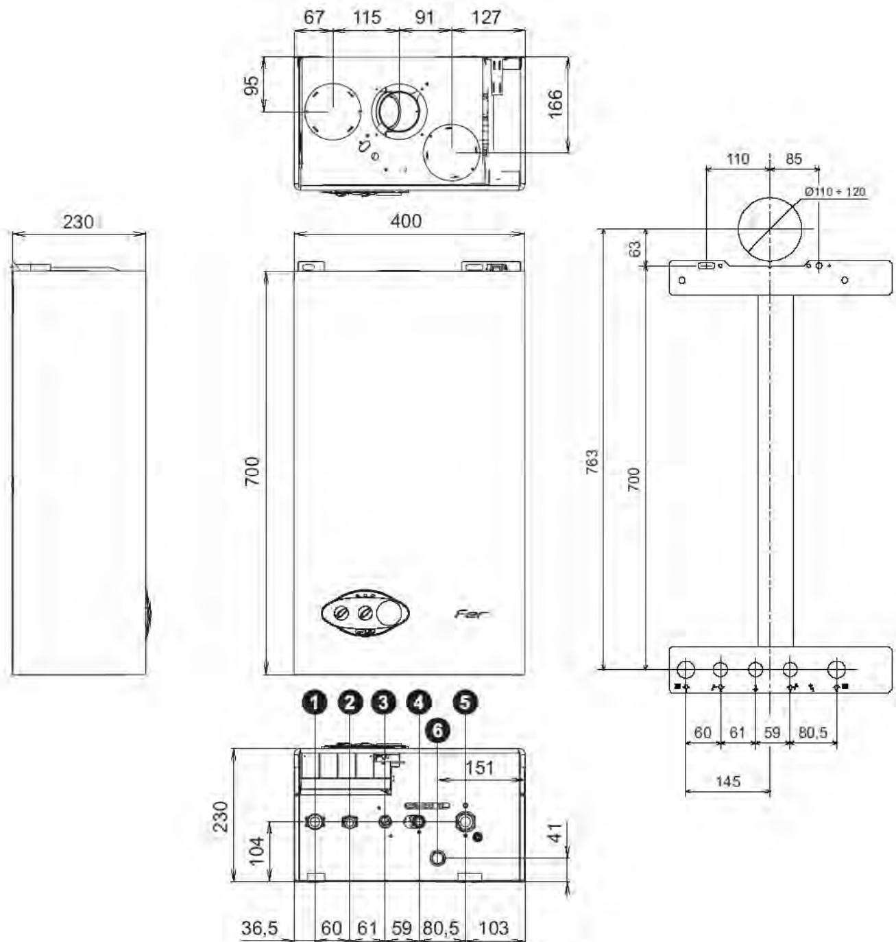
рис. 18 - Габаритные размеры и подключения
