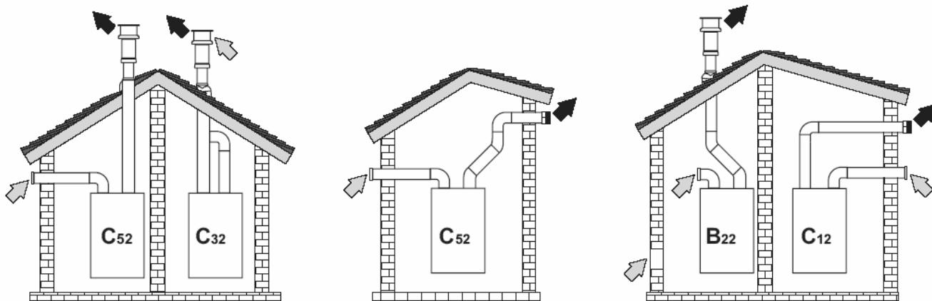
рис. 11 - Примеры подсоединения с помощью раздельных труб (➡ = Воздух / ⬅ = Продукты сгорания)
