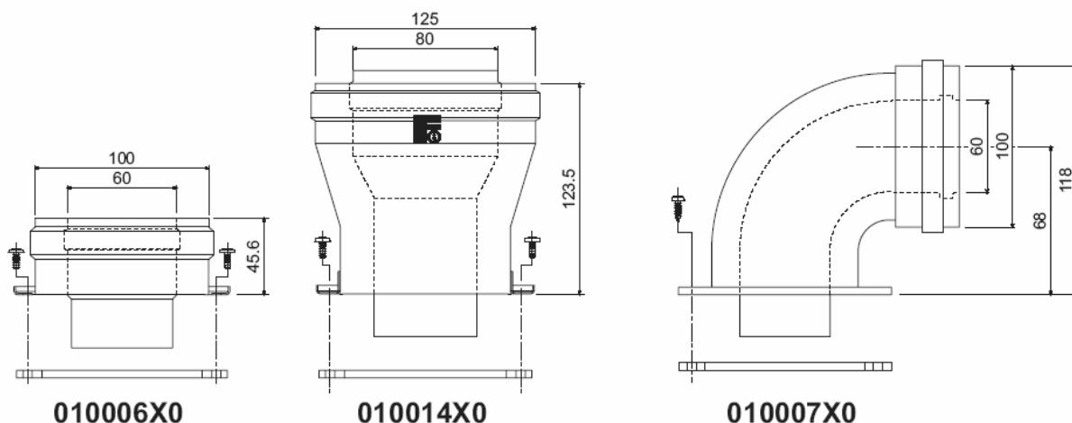
рис. 10 - Исходные элементы для коаксиальных воздуховодов
