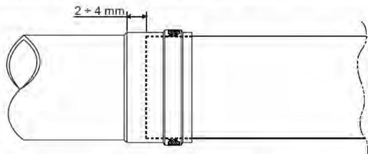
рис. 7 - Тепловое расширение
