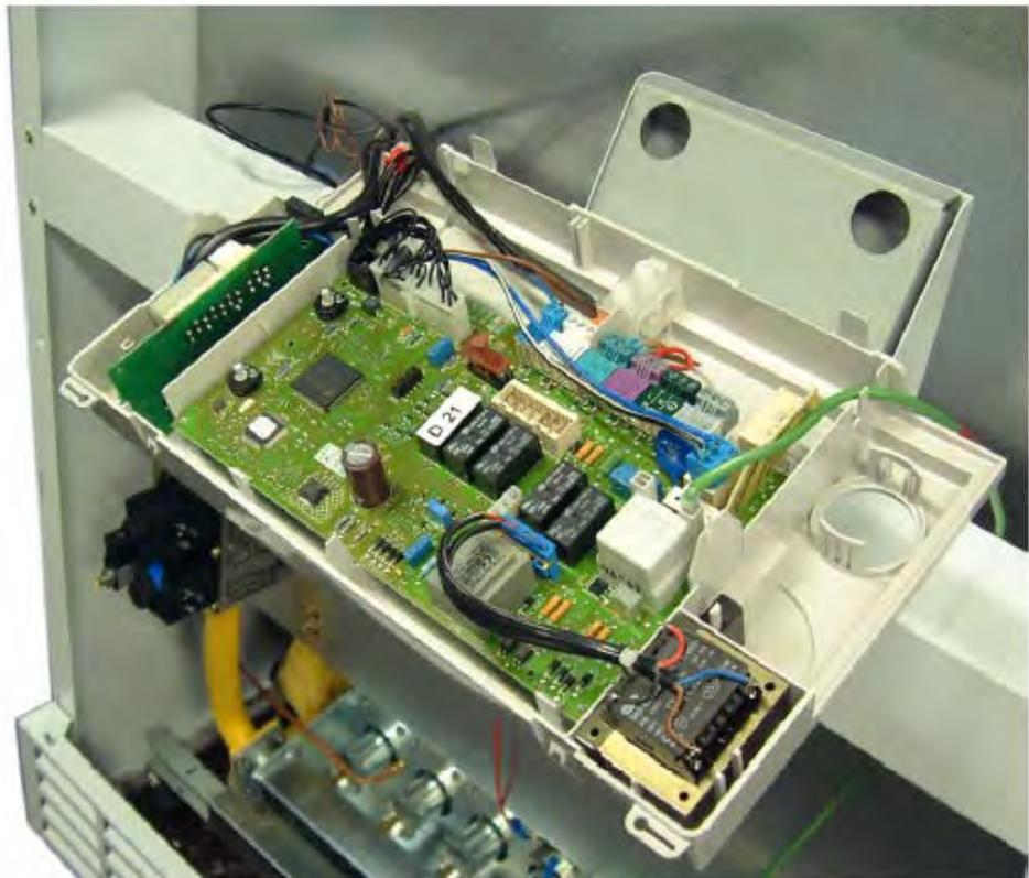
**Блок электроники E-Box atmoCRAFT с основной электронной платой и дополнительной платой**
