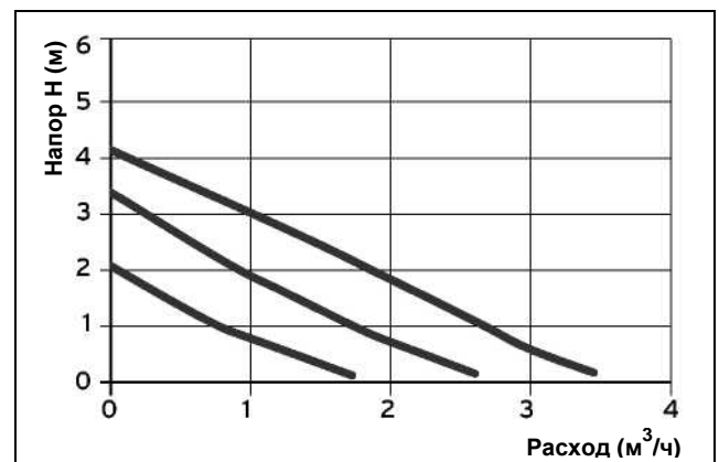
Рис. 1.7 Характеристика 3-ступенчатого насоса
